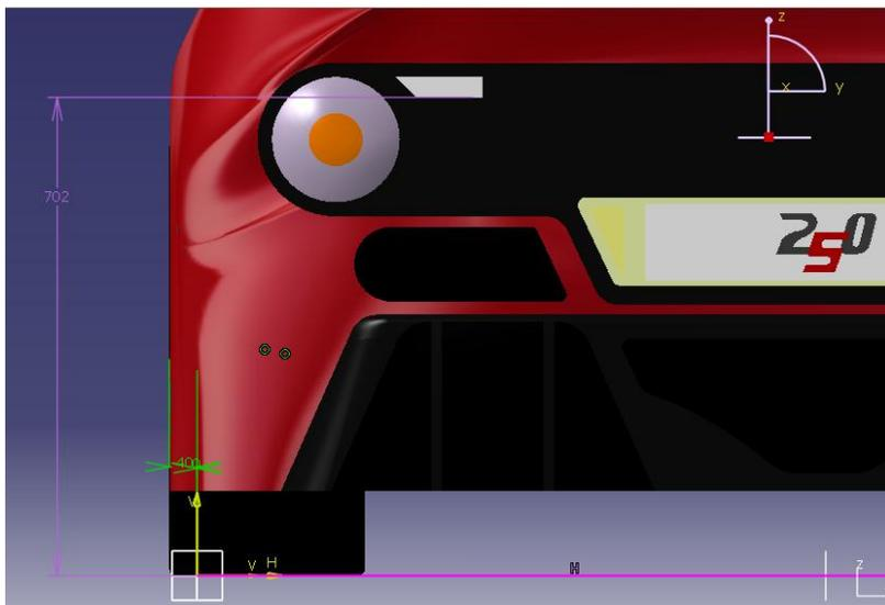
**Figura 4.6 Altezza da terra del catadiottro 702mm**
